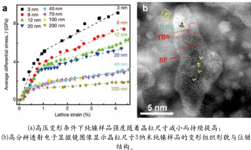
(a)高压变形条件下纯镍样品强度随着晶粒尺寸减小而持续提高；
